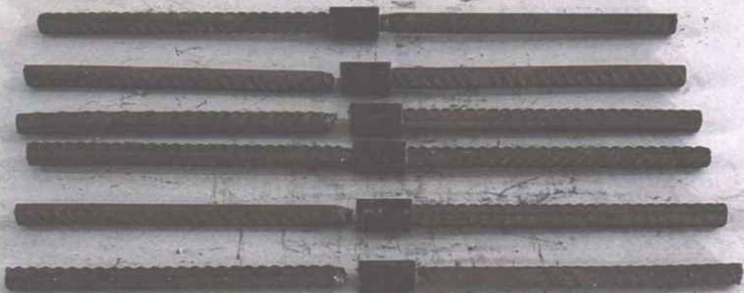
ООО СК «Авангард Стиль» Механические резьбовые соединения арматурного проката с помощью муфт Ø 20 мм А500С
