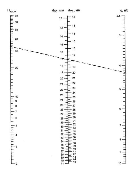
$^{d}$  50 ,  $^{d}$  70 - диаметры отверстий диафрагм, устанавливаемых у пожарных кранов диаметром 50, 65 (70) мм
