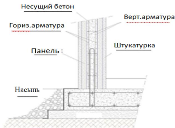
Рисунок 13.1 – Анкерное крепление панелей на фундамент
