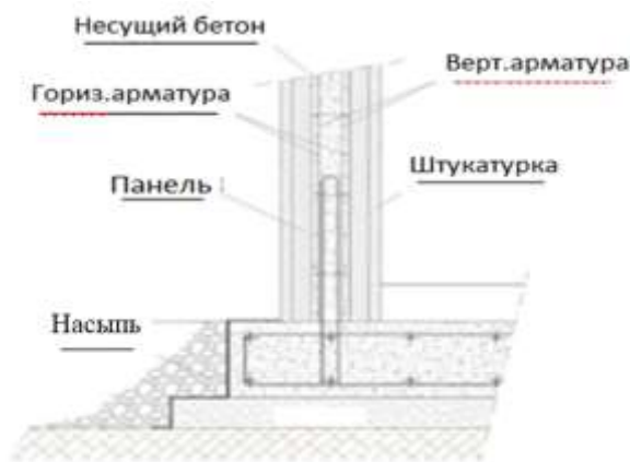
Рис 13.2 Анкерное крепление панелей на фундамент
