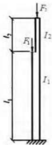
Рисунок 3.1 – Схема одноступенчатой колонны при верхнем конце, свободном от всяких закреплений, по табл. 3.1
