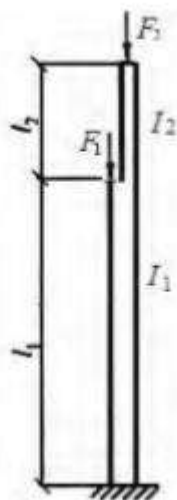
Рис. 3.1. Схема одноступенчатой колонны при верхнем конце, свободном от всяких закреплений, по табл. 3.1
